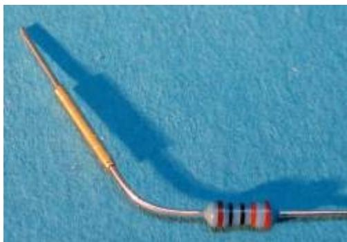
Zunächst muß das Röhrchen sorgfältig entgratet und alle Kanten geglättet werden. Eine Nagelfeile und ein 1mm Bohrer helfen dabei. Mit Hilfe des Anschlussbeinchen des Widerstandes kann dann die Durchgängigkeit des Messingrohres geprüft werden.
