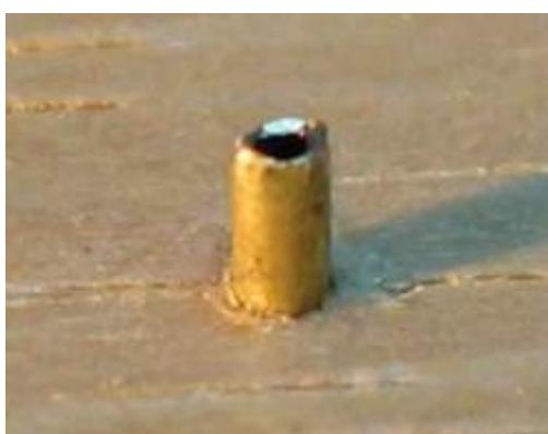
Ein ebenes Stück Hartholz kann nun helfen, das Röhrchen winklig in das Lampengehäuse zu bekommen. Dazu wird in das Holz ein Loch rechtwinklig mit 1mm bis 1,2 mm gebohrt.
