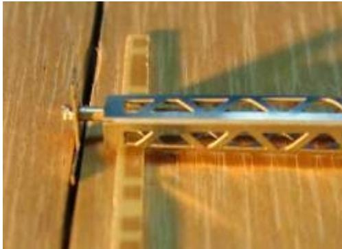
Klemmt man den Mast mit einem Gewicht nach dem Ausrichten auf das Holzbrett, kann das Rohr am Mastende verlötet werden. Auch hier ist darauf zu achten, das kein Lötzinn in das Röhrchen läuft. Natürlich können alle Verbindungen auch mittels einer Verklebung hergestellt werden. Allerdings ist dabei darauf zu achten, dass die Teile nicht mit dem Holzbrett verkleben.
